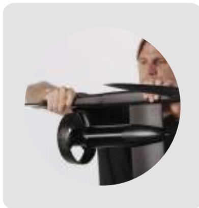
Installare il kit ali appena assemblato sul mast, fissandolo con le due viti M6x30mm utilizzando la chiave a brugola da 4mm. Una volta correttamente unite le ali al mast, girare la tavola e aprire il comparto botola.
